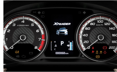
شاشة متعددة المعلومات (ملونة TFT LCD) Multi-information display (TFT color LCD)
