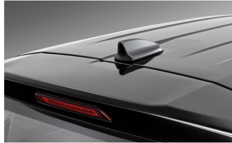
هوائي بتصميم زعنفة سمكة القرش Shark fin antenna
