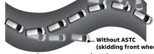
بدون نظام التحكم بالنشط بالثبات (انزلق العجلات الأمامية) Without ASC (skidding front wheels)
