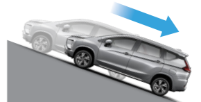
بدون نظام التحكم المساعد للإقلاع على المرتفعات Without Hill Start Assist
